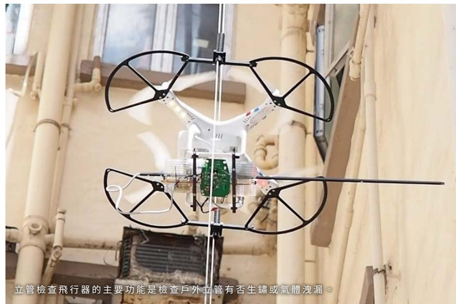
立管檢查飛行器的主要功能是檢查戶外立管有否生鏽或氣體洩漏。
