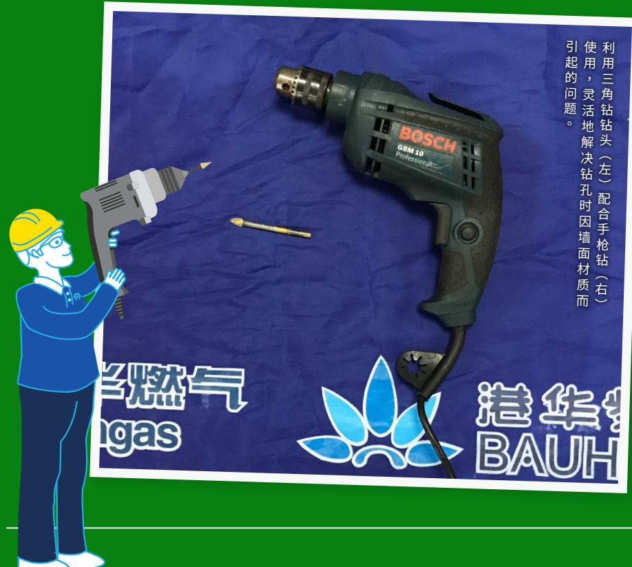
装燃气炉具。例如，有客户将原本用于地面装饰的地砖改作墙面装饰，我们若在这种墙面材质上使用普通冲击钻打孔安装，会导致打孔效果不理想、不美观。最后我们想出由普通冲击钻改用三角钻钻头加手枪钻一起使用，灵活地解决了因墙面材质而引起的问题，既可降低成本，又能改善工作效率，大大提高客户满意度。」廖孔桂对在工作上使用创新方法充满热情。
